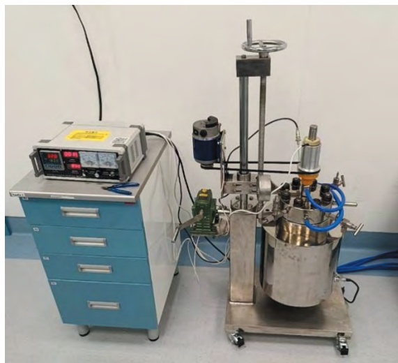
Рисунок 1. Установка для гидротермального синтеза гидроксиапатита Figure 1. Hydrothermal plant for hydroxyapatite synthesis
