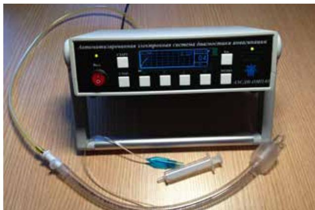
**Рис. 1 Автоматизированная электронная система диагностики инвагинации кишечника у детей на основе объемно-манометрической пробы – ОМП.**
